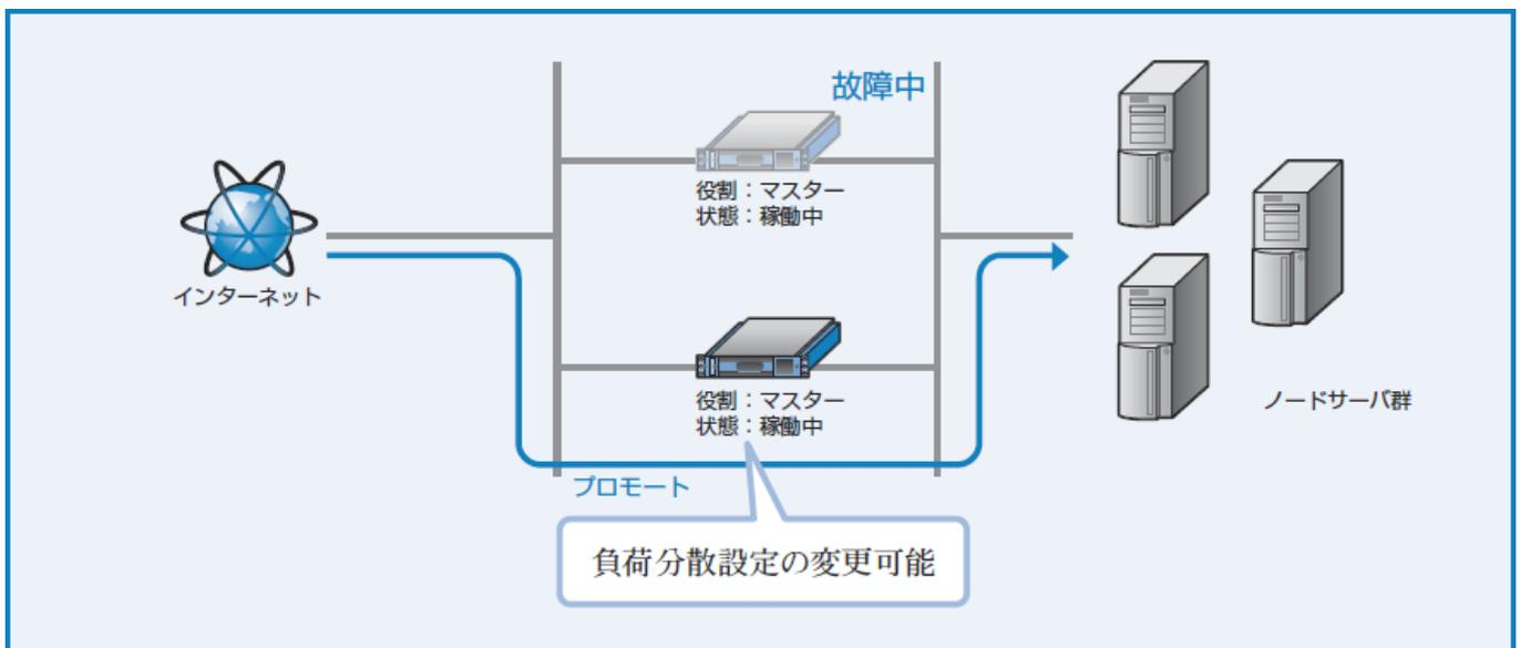
図3-19 プロモートにより、マスターに昇格
