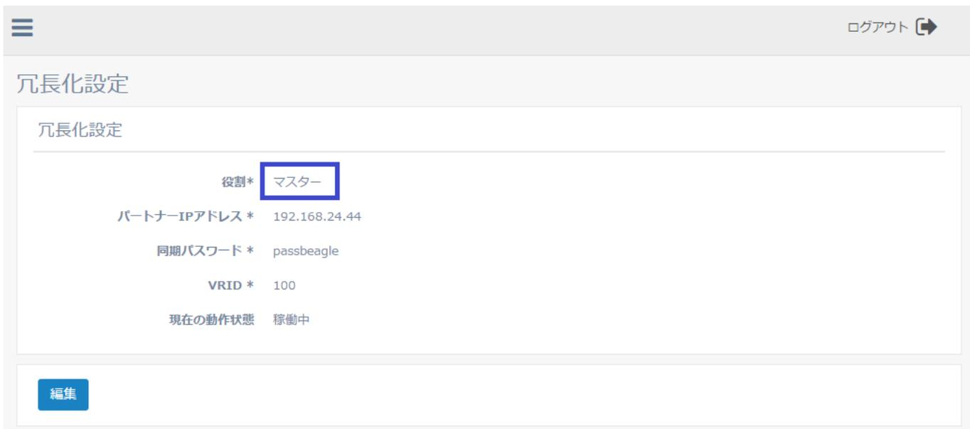
図3-23 プロモートによりマスターに昇格
