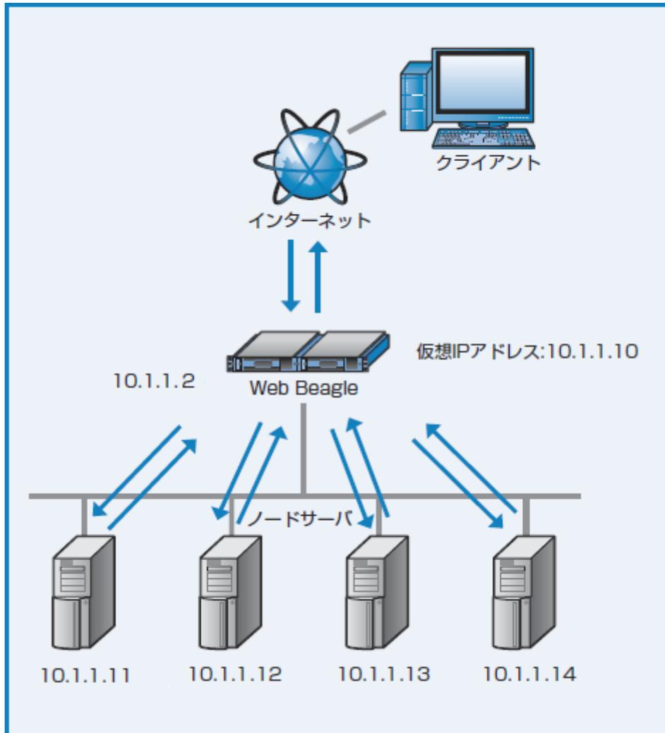
図2-3 透過型のネットワーク構成
